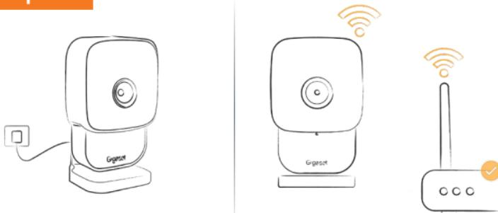
Netzteil mit der **Gigaset camera 2.0** verbinden. Fuß installieren und **Gigaset camera 2.0** an einem Platz mit guter WLAN-Verbindung anbringen. Eine geringe Signalstärke kann zu Funktionseinschränkungen führen.
