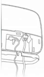
2. Spojite LAN kabel na internet usmjerivač i **base** (pomoću otvora na podnožju). Kada je ovo radilo, srednja LED svijetli.
