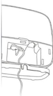
1. Spojite jedinicu za napajanje na **base** i na utikač u blizini vašeg internet usmjerivača (pomoću otvora na **base**). Kada najgornja LED dioda na **base** svijetli, to znači da radi.
