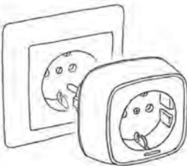
**plug** im Zimmer einstecken wo man ihn benötigt. Unter „Regeln“ und „Konfiguration“ **plug** einstellen und über das Widget steuern.
