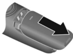
Снятие крышки аккумуляторного отсека:
