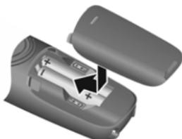
▶ Установите на место крышку аккумуляторного отсека, начиная с верхнего края.
