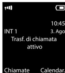
Se l'indicazione di stato è attivata, sul display di standby vengono visualizzati messaggi corrispondenti. In presenza di più messaggi attuali, viene visualizzato quello con la priorità superiore, ad es.
