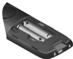
▶ Colocar las baterías (con los polos +/- en la posición correcta, véase la imagen).
