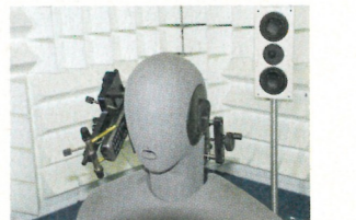
Kopfarbeiter: Die Messungen im Telefonbetrieb erfolgen an einem künstlichen Kopf.
